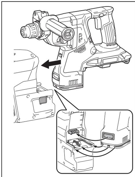
Для снятия системы пылеулавливания потяните инструмент, нажимая при этом кнопку блокировки в выключенном положении.
