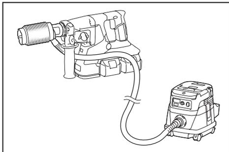
3. Установите выключатель режима ожидания на пылесосе в положение «AUTO» (автоматический).
