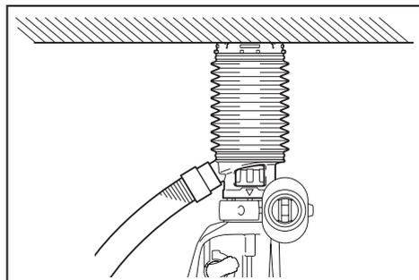
**ПРИМЕЧАНИЕ:** Не используйте колпак для пыли в сборе при сверлении металла или аналогичного материала. Это может привести к повреждению колпака для пыли в сборе нагретыми металлическими или подобными частицами.
