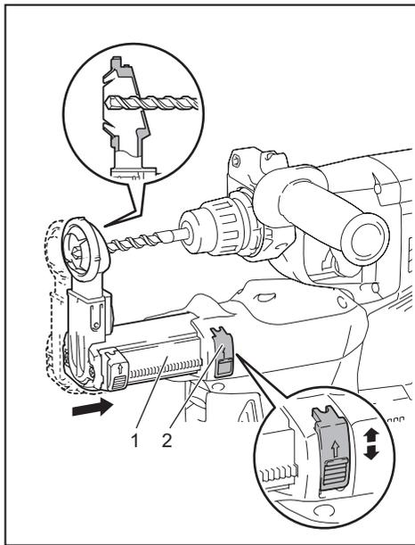
► 1. Направляющая 2. Кнопка регулировки направляющей
