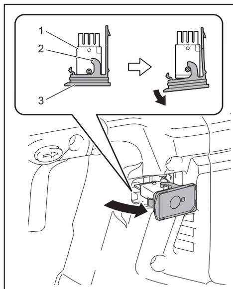
► 1. Беспроводной блок 2. Крючок 3. Крышка
