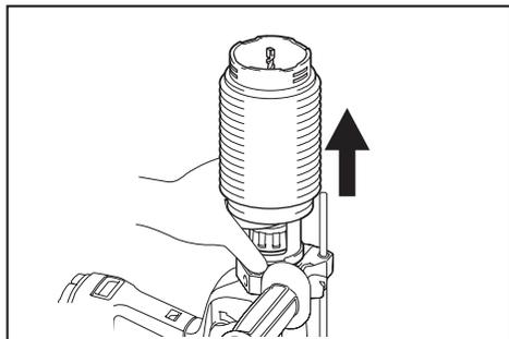
**ПРИМЕЧАНИЕ:** Если крышка отсоединилась от колпака для пыли, прикрепите ее так, чтобы сторона с печатью была направлена вверх, а выступ на крышке располагался внутри периметра дополнительного оборудования.
