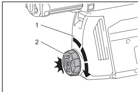
► 1. Корпус для сбора пыли 2. Регулятор со шкалой
