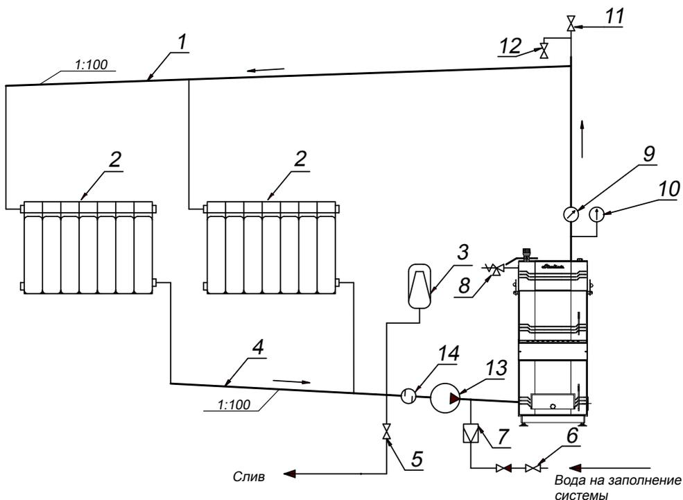
1. Труба на подающем трубопроводе Ду 25; 2. Отопительная батарея; 3. Расширительный бак; 4. Труба на обратном трубопроводе Ду 25; 5. Вентиль слива; 6. Вентиль холодной воды на заполнение системы; 7. Редукционный и обратный клапана для заполнения системы; 8. Предохранительный клапан; 9. Термометр; 10. Манометр; 11. Автоматический воздухоотводчик; 12. Труба Ду 15 с вентилем; 13. Циркуляционный насос; 14. Сетчатый фильтр.
