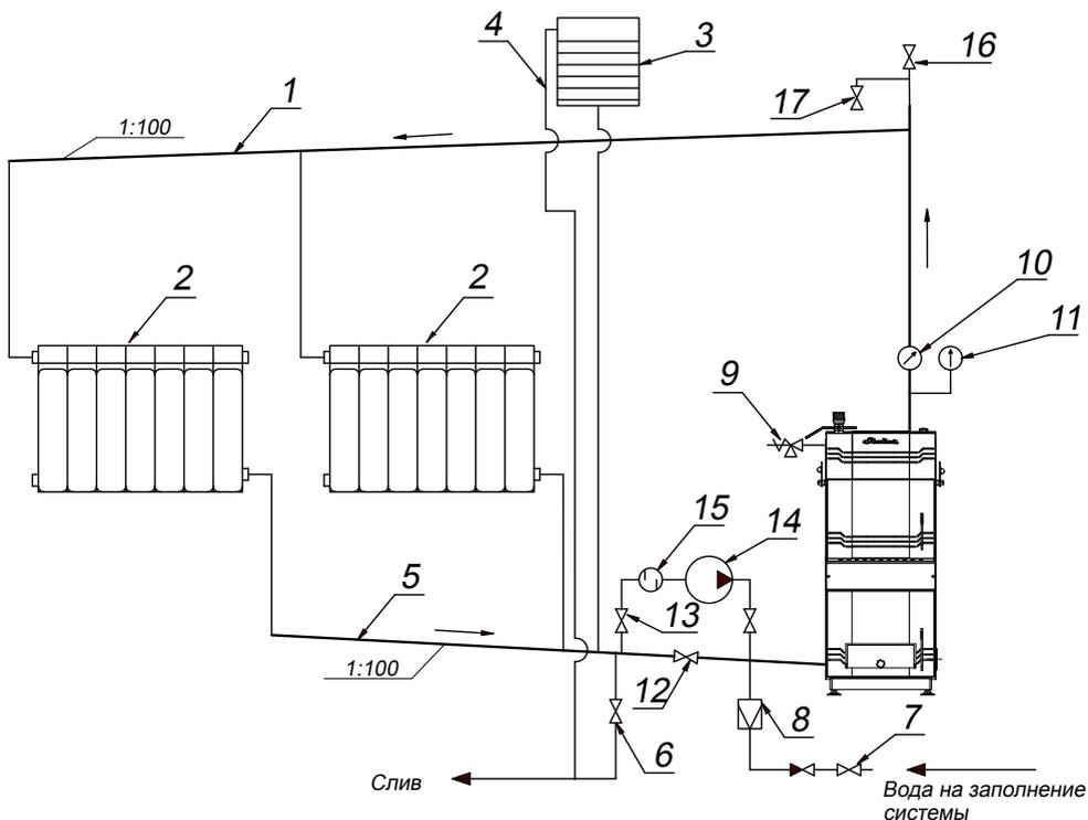
1. Труба на подающем трубопроводе Ду 32; 2. Отопительная батарея; 3. Расширительный бак; 4. Труба перелива; 5. Труба на обратном трубопроводе Ду 32; 6. Вентиль слива; 7. Вентиль холодной воды на заполнение системы; 8. Редукционный и обратный клапана для заполнения системы; 9. Предохранительный клапан; 10. Термометр; 11. Манометр; 12. Вентиль байпаса; 13. Отключающие вентиль; 14. Циркуляционный насос; 15. Сетчатый фильтр; 16. Автоматический воздухоотводчик; 17. Труба Ду 15 с вентилем.
