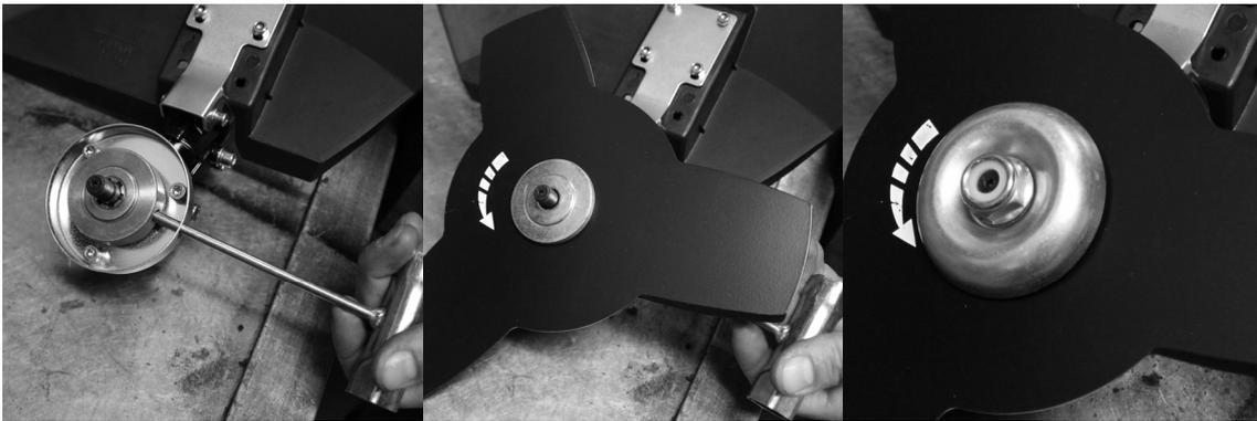
Крепление режущего диска: совместите отверстие в ступице вала с отверстием в чашке редуктора.
