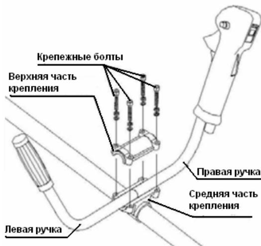
Для крепления рукоятки управления к штанге используется узел крепления рукоятки управления. Он состоит из верхней части крепления, крепежных болтов, нижней и средней частей крепления, расположенной на штанге.
