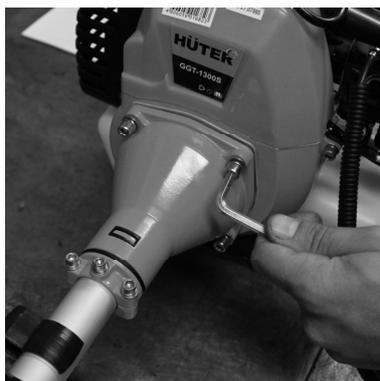
Присоедините двигатель к штанге и закрепите большими болтами из комплекта.
