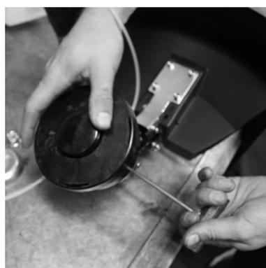
Крепление головки с леской: Совместите отверстие в ступице вала с отверстием в чашке редуктора. Вставьте металлический стопорный стержень в отверстие в чашке редуктора и в отверстие в ступице вала. Открутите гайку крепления со ступицы изделия. Снимите чашку с вала, оставив ступицу. Удерживая стержень, закрутите катушку против часовой стрелки до упора.
