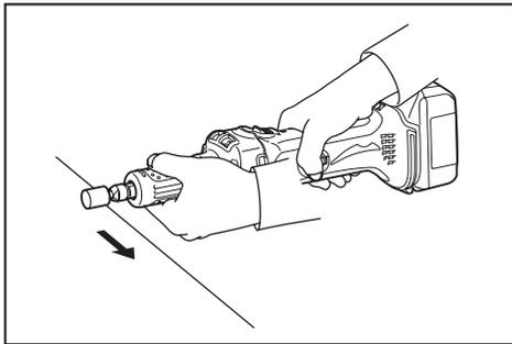
Включите инструмент, не касаясь дисковым наконечником обрабатываемой детали, и подождите, пока дисковый наконечник наберет полную скорость. Затем осторожно приложите дисковый наконечник к обрабатываемой детали. Для достижения хорошей отделки, медленно перемещайте инструмент влево.
