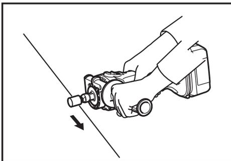
При использовании боковой ручки снимите резиновую заглушку, до конца вставьте боковую ручку в цилиндрическую часть инструмента и поверните ее под желаемым углом. Затем надежно затяните ручку, вращая ее по часовой стрелке.
