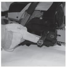
**ШАГ 1**Открутите крепежные гайки и снимите кожух защиты ведущей зведочки.
