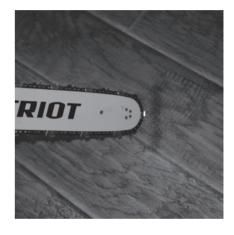
**ШАГ 3**Через несколько секунд на поверхности должны появиться следы цепной смазки. Если этого не произошло, то Вам необходимо прочистить масляные отверстия на шине (см. стр. 21).
