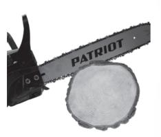
Не стоит прилагать усилия при распиловке древесины, собственный вес пилы позволяет вести процесс распиловки. Если цепь зажало, остановите двигатель, приподнимите или измените положение бревна. Не стоит дергать инструментом для освобождения цепи.
