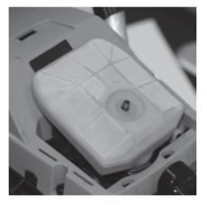
**ШАГ 2**Вытащите воздушный фильтр и тщательно промойте его в мыльном водном растворе, затем высушите. Ежедневно проверяйте состояние воздушного фильтра.
