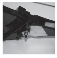
**ШАГ 2**Прочистите механические части тормоза цепи. Смажьте их графитовой или литиевой смазкой.
