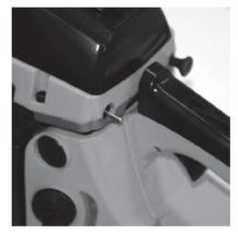
**ШАГ 2**Остановите двигатель, переведя выключатель в нижнее положение "Выключено".
