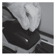
**ШАГ 1**Открутите крепежную гайку и снимите кожух защиты воздушного фильтра.
