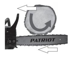
Можно начать распиловку снизу, для этого распилите бревно примерно на четверть диаметра бревна, а затем закончите распиловку сверху. Помните, если бревно не закреплено, то при начале распиловки оно может сдвинуться в сторону, противоположную движению цепи, и травмировать.
