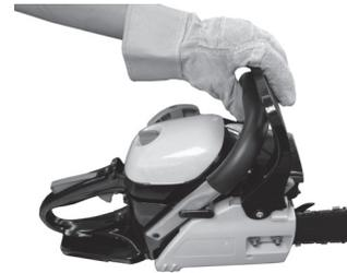
**Шаг 1.** Установите тормоз цепи в нерабочее положение, сдвинув ручку тормоза в направлении передней ручки до касания.
