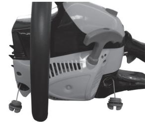
**Шаг 2.** Залейте в горловину топливного бака приготовленную смесь. В горловину бака для смазки цепи залейте цепное масло. Баки для топлива и смазки отмечены специальными значками.
