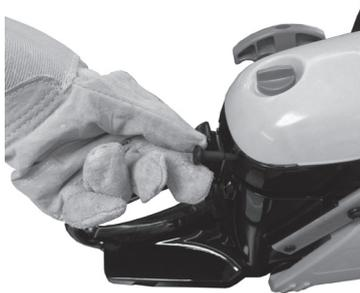
**Шаг 4.** Полностью вытяните рычаг воздушной заслонки, тем самым установив его в положение - «ЗАПУСК».
