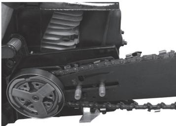
**Шаг 3.** Наденьте цепь на ведущую звездочку и вставьте её хвостовики в паз пильного полотна. Начните эту операцию с верхней части пильного полотна. Убедитесь, что кромки режущих звеньев на верхней части полотна направлены к ведомой звезде пильного полотна. На шине нарисован правильно установленный режущий профиль звена. Установите штифт механизма натяжения цепи в специальное отверстие на полотне шины.
