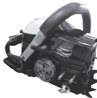
**Шаг 1.** Открутите гайки для крепления пильного полотна и снимите защитную крышку вместе с тормозом цепи.
