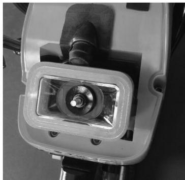
**Воздушный фильтр. Шаг 2.** Проверьте состояние воздушного фильтра каждый раз перед началом и после окончания работ. При загрязнении бумажного воздушного фильтра его требуется заменить.
