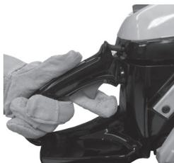
**Шаг 7.** Дайте двигателю прогреться 15 - 20 секунд. Однократно нажмите на блокиратор и курок газа полностью, рычаг воздушной заслонки автоматически перейдет в рабочее положение.
