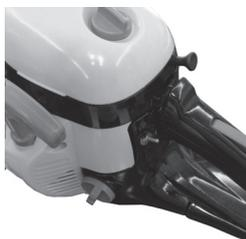
**Запуск прогретого двигателя.** Если двигатель прогрет, выполните те же процедуры, что и при холодном запуске, только не вытягивайте воздушную заслонку и не нажимайте на праймер.
