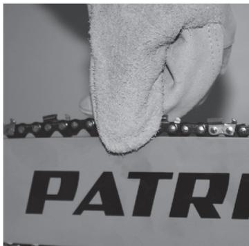
**Шаг 6.** Натяните цепь с помощью отвертки, закручивая винт механизма регулировки цепи по часовой стрелке. Цепь необходимо натягивать до тех пор, пока она не будет плотно прилегать к нижней части пильного полотна.
