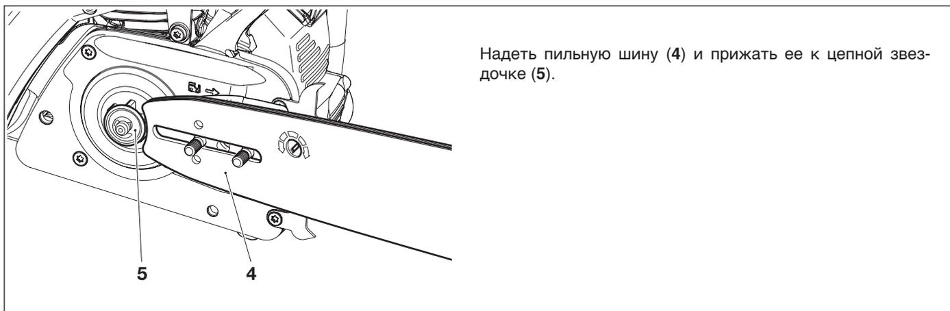
Надеть пильную шину (4) и прижать ее к цепной звезде (5).
