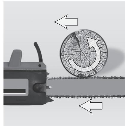
Можно начать распиловку снизу, для этого распилите бревно примерно на четверть диаметра бревна, а затем закончите распиловку сверху. Помните, если бревно не закреплено, то при начале распиловки оно может сдвинуться в сторону противоположную движению цепи и травмировать.
