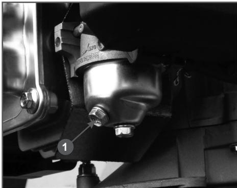
Рис. 19 Сливной болт поплавковой камеры карбюратора
