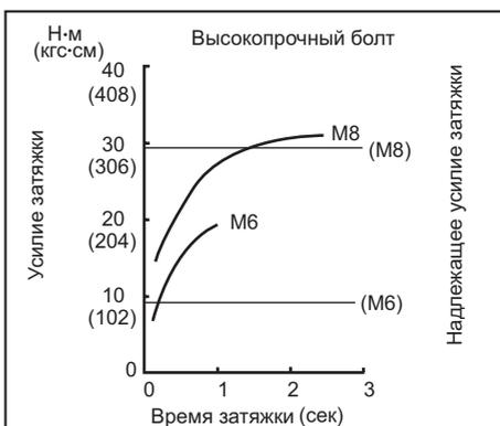
Соответствующий крутящий момент затяжки может отличаться в зависимости от типа или размера винта/болта, материала закрепляемой рабочей детали и т.д. Перед началом работы всегда выполняйте пробную операцию для определения надлежащего времени затяжки для Вашего винта.
