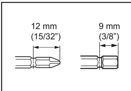
Используйте сменные наконечники (отвертки и головки) только таких типов, которые показаны на рисунке.
