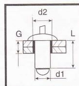
d1 – Диаметр рабочей части заклепки
