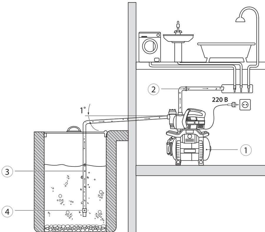
Чтобы избежать протечек и потери давления, соединения трубопроводов должны быть абсолютно герметичными. Соединение станции с трубопроводами должно осуществляться без перекосов, чтобы внутреннее напряжение в трубопроводе не создавало препятствий для нормальной работы станции.
