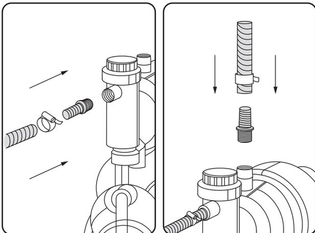
Подключите заборную магистраль, используя штуцер с наружной резьбой диаметром 1". На заборной магистрали не допускается использовать быстросъемные соединения. Рекомендуется использовать всасывающий комплект для насоса Denzel артикул 97283.
