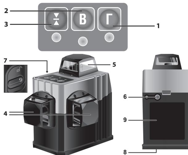
1. Кнопка включения горизонтальной линии
