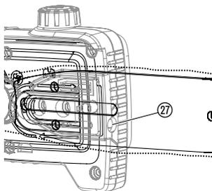
1. Приподнимите цепь ⑳ над шиной в ее середине ⑬. Зазор должен составлять 2 – 3 мм.
