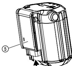
4. Сначала выньте из аккумулятора ⑤ вилку кабеля зарядки ⑦, а затем выньте зарядное устройство ⑧ из розетки электросети.
