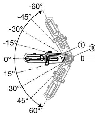
Узел мотора ① можно наклонять ступенями по 15° на угол от 60° до - 60°.
