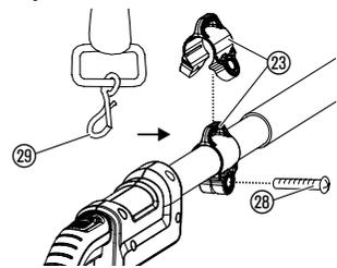
1. Раскройте зажим для ремня ⑳, закрепите его на стержне и зажмите болтом ㉑.
