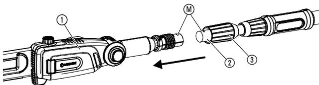
1. Задвинуть телескопическую трубу ② в блок мотора ① до упора. При этом должны совместиться обе метки М.
