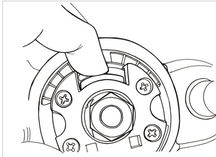
Рис.2 Блокировка шпинделя
