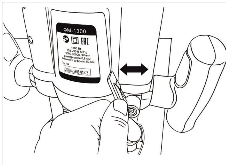
Рис.7 Фиксирующий рычаг
