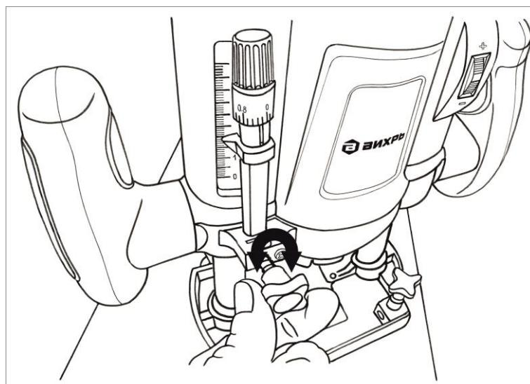
Рис.7 Фиксатор регулировки
