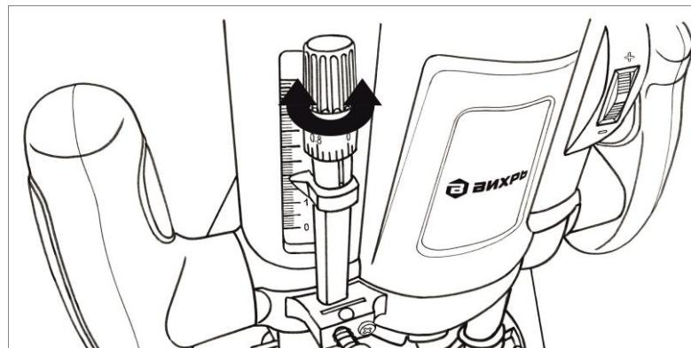
Рис.5 Точная регулировка
