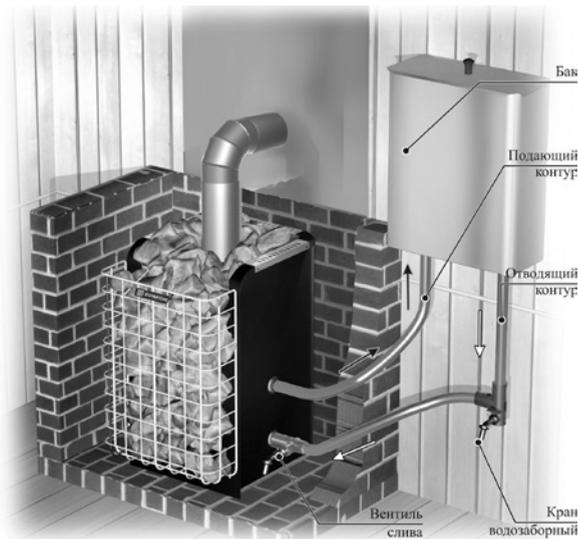
Скорость нагрева воды увеличится, если организовать, подъем подающего контура не менее 20°, уклон отводящего контура не менее 2°, в направлении от печи к баку. Система должна обеспечивать полный слив воды, а вентиль слива необходимо разместить в самой нижней точке системы (обратный контур).
