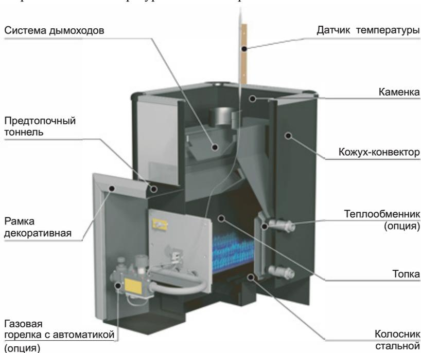
**Рисунок-1.** Конструкция печи.
