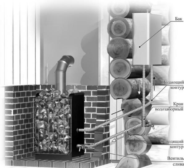
Скорость нагрева воды увеличится, если организовать, подъем подающего контура не менее  $20^\circ$ , уклон отводящего контура не менее  $2^\circ$ , в направлении от печи к баку. Система должна обеспечивать полный слив воды, а вентиль слива необходимо разместить в самой нижней точке системы (обратный контур).
