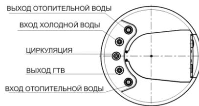
**Техническое описание:** ОКС 80 NTR/Z, ОКС 100 NTR/Z, ОКС 125 NTR/Z, ОКС 160 NTR/Z, ОКС 200 NTR/Z
