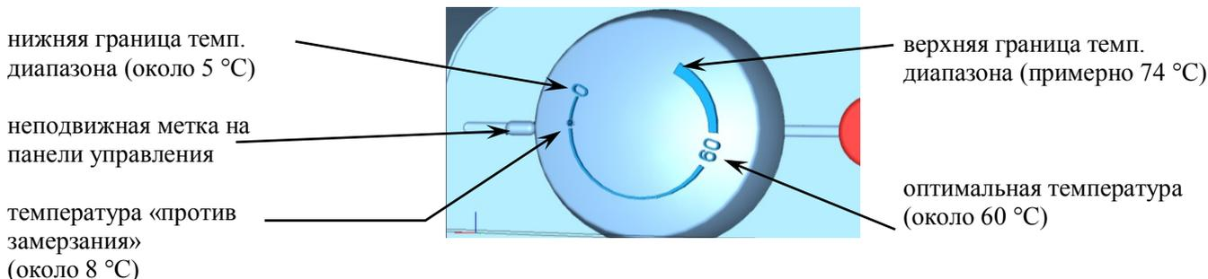
**Предупреждение:** установка переключателя термостата на левом упоре не означает постоянного выключения нагревательного элемента.
