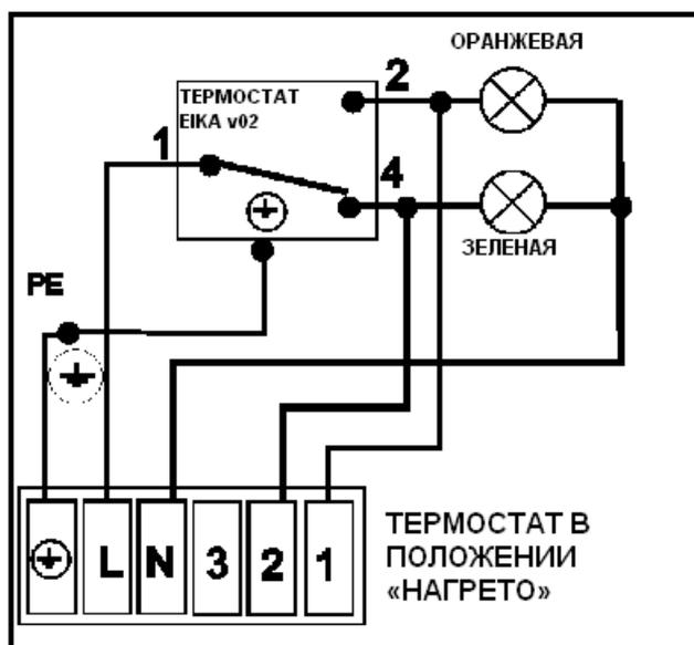
На панели управления имеется контактный термометр для контроля температуры воды, управление капиллярным термостатом для настройки требуемой температуры воды и две сигнальные лампочки: зеленая = водонагреватель нагрет, оранжевая = водонагреватель продолжает нагреваться.
