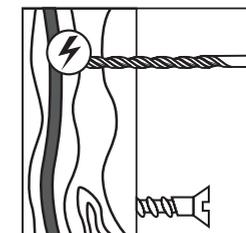
При сверлении стен / заворачивании крепежа в стены предварительно убедитесь в отсутствии в данном месте скрытой проводки.
