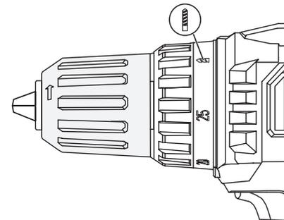
Во избежание травм, не заворачивайте шурупы в положении
