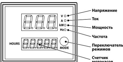
Вольтметр (13) позволяет отображать текущее значение напряжения.
