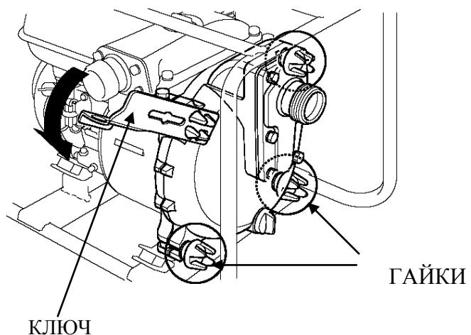
3. Снимите крышку насоса и выньте спиральную камеру из корпуса насоса. Очистите корпус насоса и спиральную камеру от возможной грязи.
