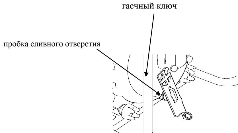
2. При помощи гаечного ключа ослабьте гайки крепления крышки насоса.
