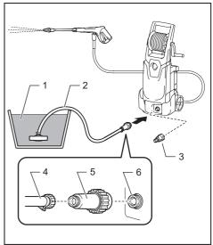
1. Бак/резервуар 2. Набор с всасывающим шлангом 3. Соединитель водяного шланга 4. Шланг
