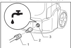
▶ 1. Соединительная муфта 2. Соединитель водяного шланга 3. Входное отверстие водоструйного аппарата высокого давления
