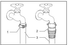
1. Хомут шланга 2. Соединительный элемент водопроводного крана 3. Устойчивый к давлению водяной шланг
