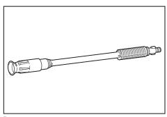
Вы можете регулировать ширину струи в диапазоне от  $0^\circ$  до  $25^\circ$  путем поворота передней части насадки.
