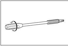
Давление струи можно отрегулировать путем поворота насадки.
