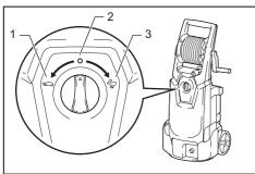
▶ 1. Режим низкого давления 2. Положение OFF (Выкл.) 3. Режим высокого давления
