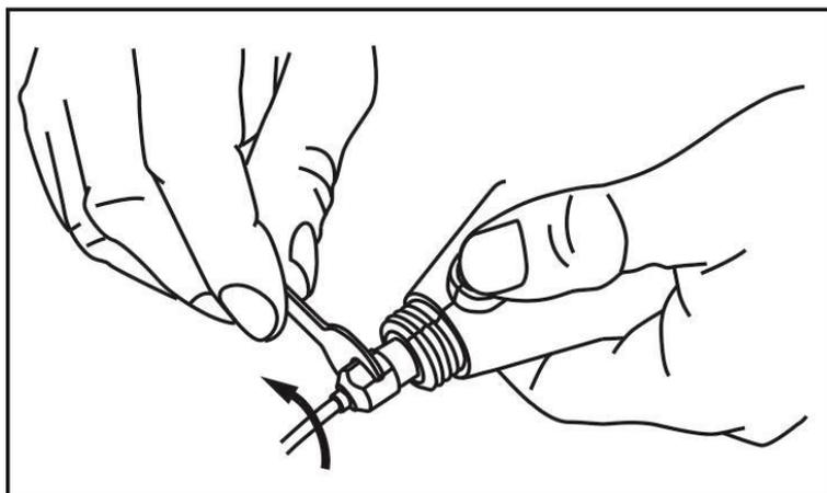
Рис.3 Установка насадок
