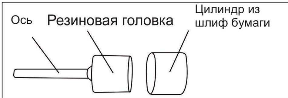
Рис.6 Установка цилиндра из шлиф бумаги
