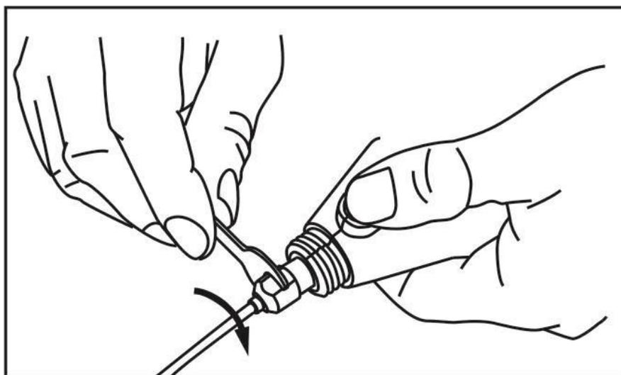
Рис.9 Откручивание гайки
