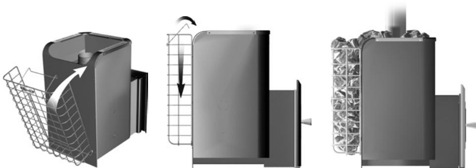
**Рисунок-10.** Установка сетки-каменки на печь.
