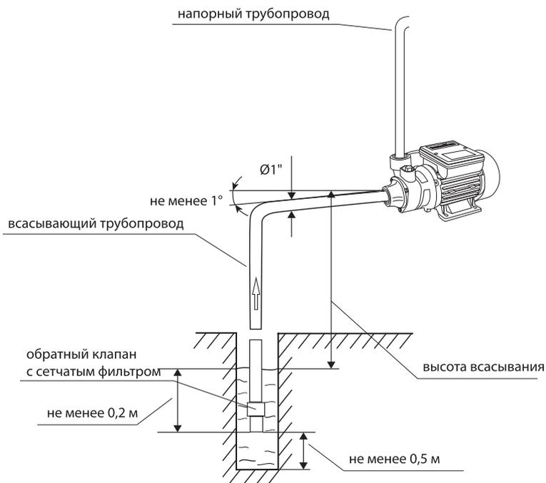
Откройте выход напорной магистрали. Наполните заборную магистраль и насос через заливное отверстие водой при помощи воронки. Когда уровень жидкости поднимется и заполнит насосную часть, вытеснив из неё воздух, закройте отверстие и включите насос в сеть.
