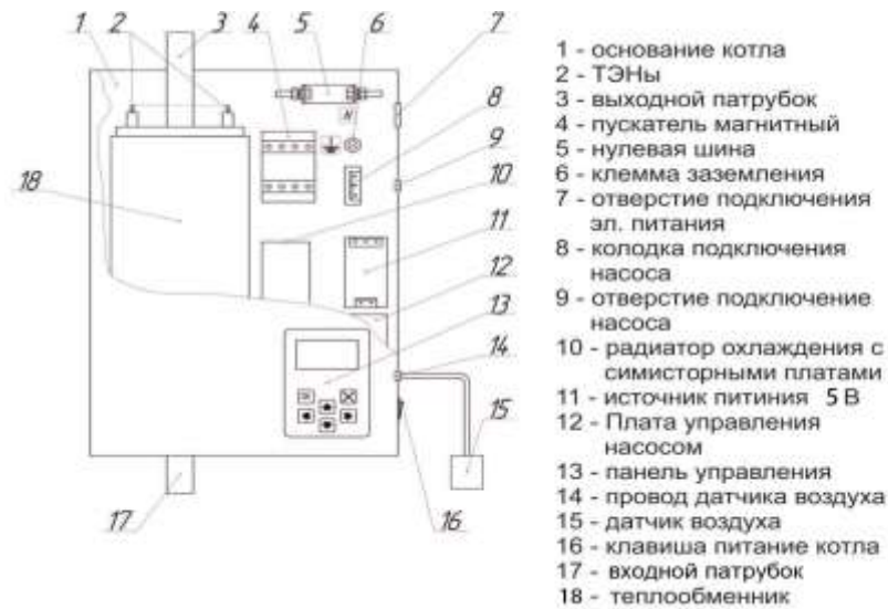
Рисунок 1. Устройство отопителя РЭКО серии П
