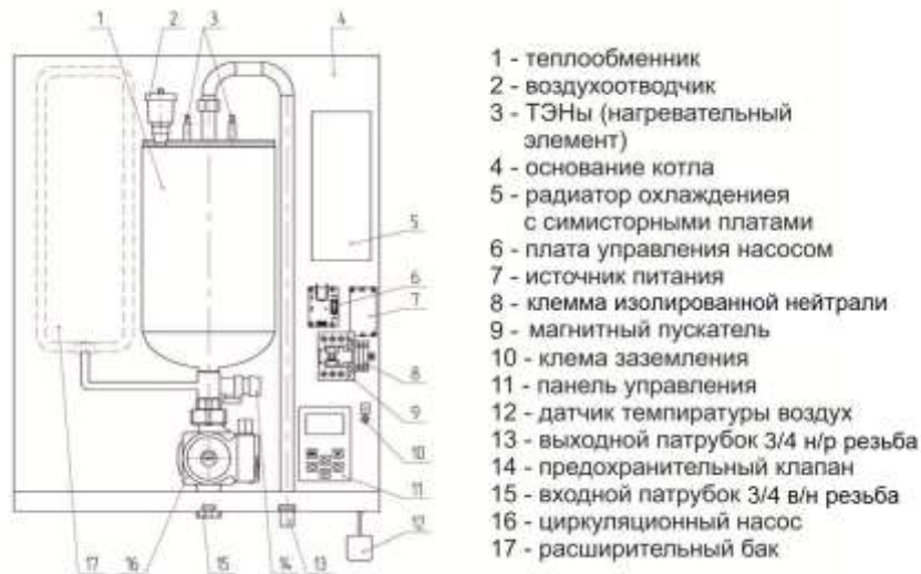
Рисунок 2. Устройство отопителя РЭКО серии ПМ
