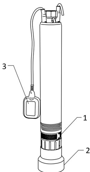
Насосы UNIPUMP серии ECO FLOAT представляют собой центробежные моноблочные многоступенчатые насосы с корпусом из нержавеющей стали.
