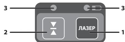
1. Кнопка «Лазер» включения горизонтальной и вертикальной линии
