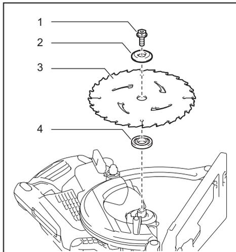
► 1. Болт с шестигранной головкой 2. Наружный фланец 3. Диск циркулярной пилы 4. Внутренний фланец
