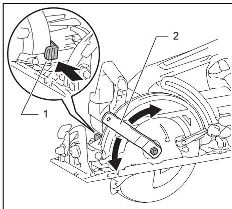
► 1. Фиксатор вала 2. Гачный ключ
