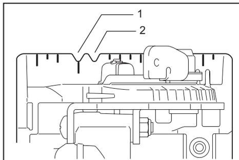
► 1. Линия разреза (положение 0°) 2. Линия разреза (положение 45°)
