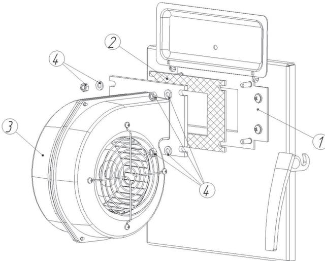
1 — дверца котла с установленным кронштейном для монтажа вентилятора наддува, 2 — прокладка паранитовая, 3 — вентилятор наддува, 4 — комплект крепежа (гайка М6 — 4шт, шайба 6 — 4шт)
