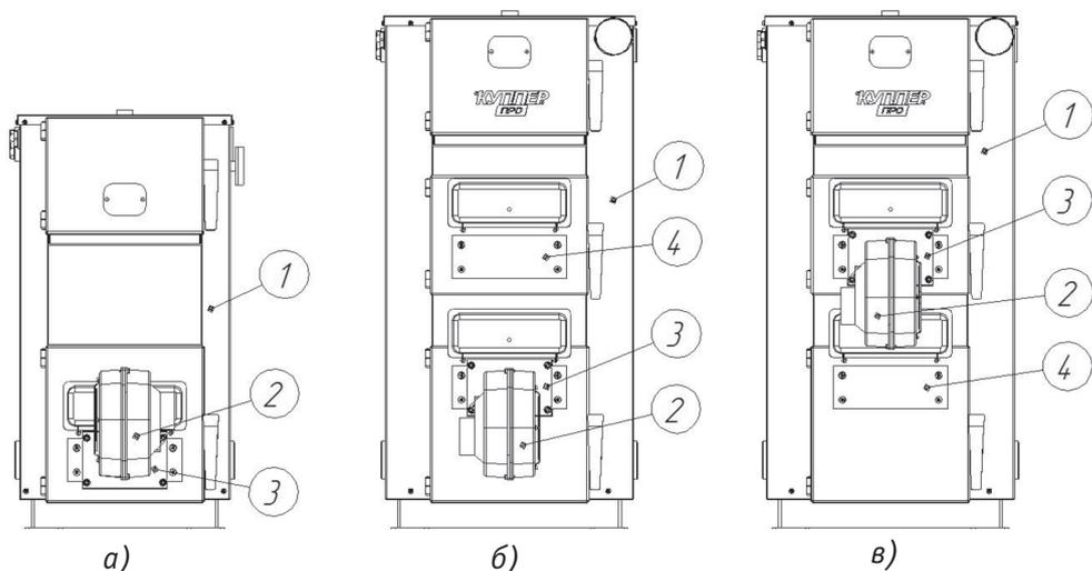
1 — котел, 2 — вентилятор наддува, 3 — кронштейн для монтажа вентилятора, 4 — заглушка подачи воздуха
