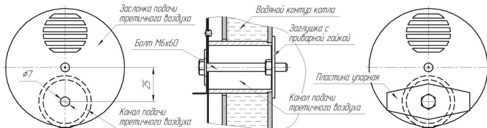
**Рисунок 6 - Установка заглушек подачи третичного воздуха**
