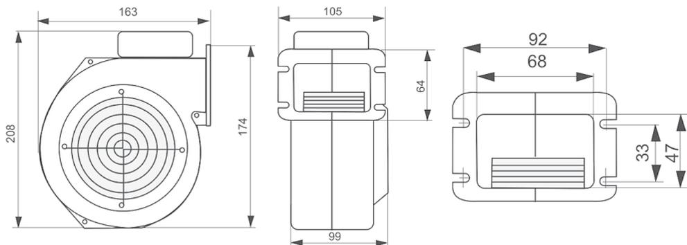
**Рисунок 1 - Габаритные и присоединительные размеры вентилятора наддува**
