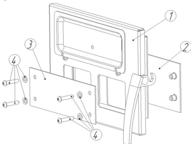
1 — дверца котла (топочная), 2 — внутренний кронштейн, 3 — наружная пластина, 4 — комплект крепежа (винт М6х30 — 4шт, шайба 6 — 4шт)
