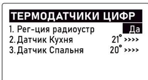
Появляется радиодатчик. Меняем ему название на “Радиодатчик Холл” и привязываем его к контуру.
