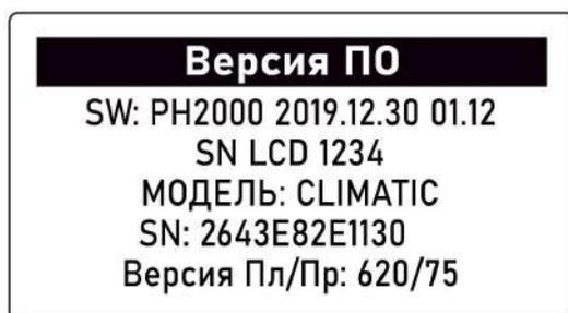
Содержит информацию о дате выпуска, серийном номере Регулятора и версии программного обеспечения.
