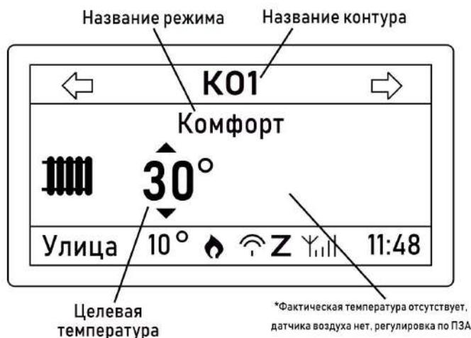
**Примечание:** При управлении по ПЗА, показания датчика температуры не отображаются.
