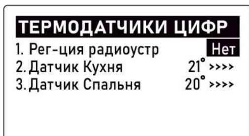
В строке “Регистрация радиоустройств” выбираем “Да”, нажимаем кнопку
