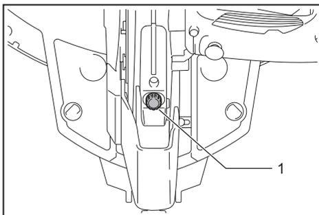
► 1. Регулировочный винт
