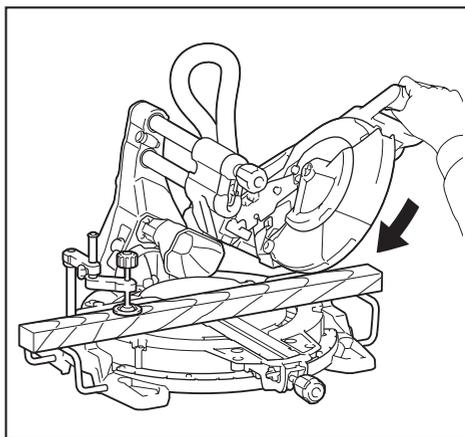
1. Снимите верхнее ограждение на той стороне, на которую производится наклон каретки.
