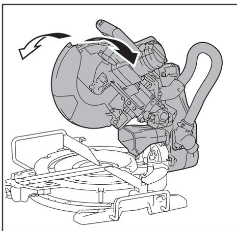
Если указатель не определяет значение 45°, переведите его в положение 45°, повернув регулировочный болт на другой стороне шкалы угла скоса.
