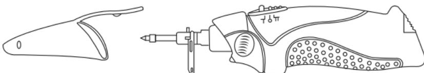
Снимите с паяльника защитный колпачок. Выключатель переведите в положение «I» или «II». С помощью припоя и флюса произведите паяльные работы. После завершения работ переведите выключатель в положение «0».
