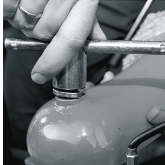
ШАГ 5 Закрепите вал рукоятки управления при помощи рычага.
