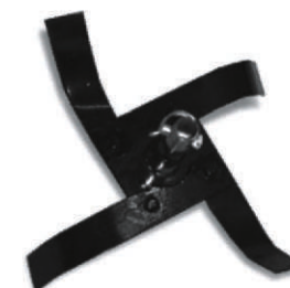
Дополнительная фреза необходима для увеличения ширины вспахивания
