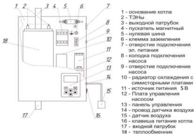
Рисунок 1. Устройство отопителя РЭКО серии П
