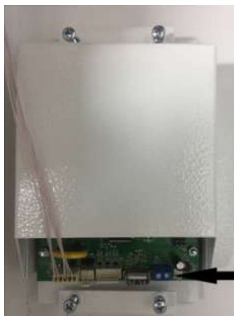
Рисунок 8. Подключение GSM модуля к электродотлу РЭКО серии П
