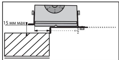
▶ регулювальником 2 встановіть глибину стругання за один прохід (для м'якого дерева можна максимальну, при твердих породах - менше);
