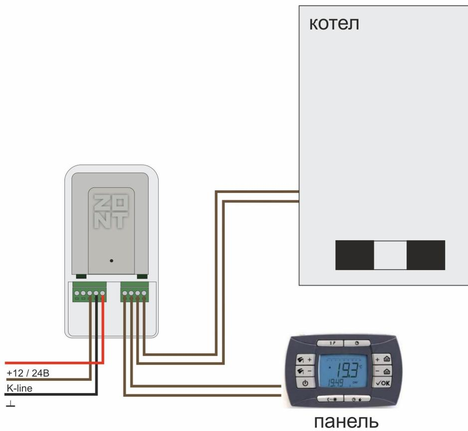
**ВНИМАНИЕ!!!** Напряжение основного питания на Адаптер при таком подключении - **24 В.**
