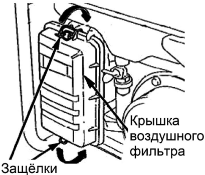
Рис. 14 Снятие крышки воздушного фильтра
